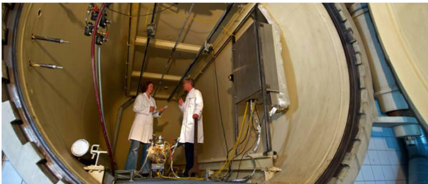
Танк общей ёмкостью 55 м 3 для масштабных испытаний на безопасность в г. Девентер, Нидерланды
