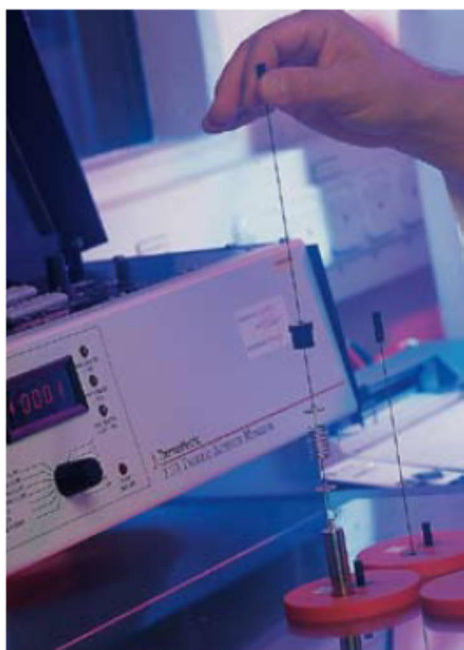
Монитор термической активности для точного измерения скорости распада органических пероксидов
